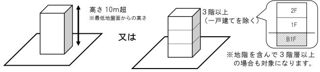
(注意) 建築物の高さの算定方法は**最低地盤面 (建築物が周囲の地盤と接する最も低い位置)** からの 測定になります。
