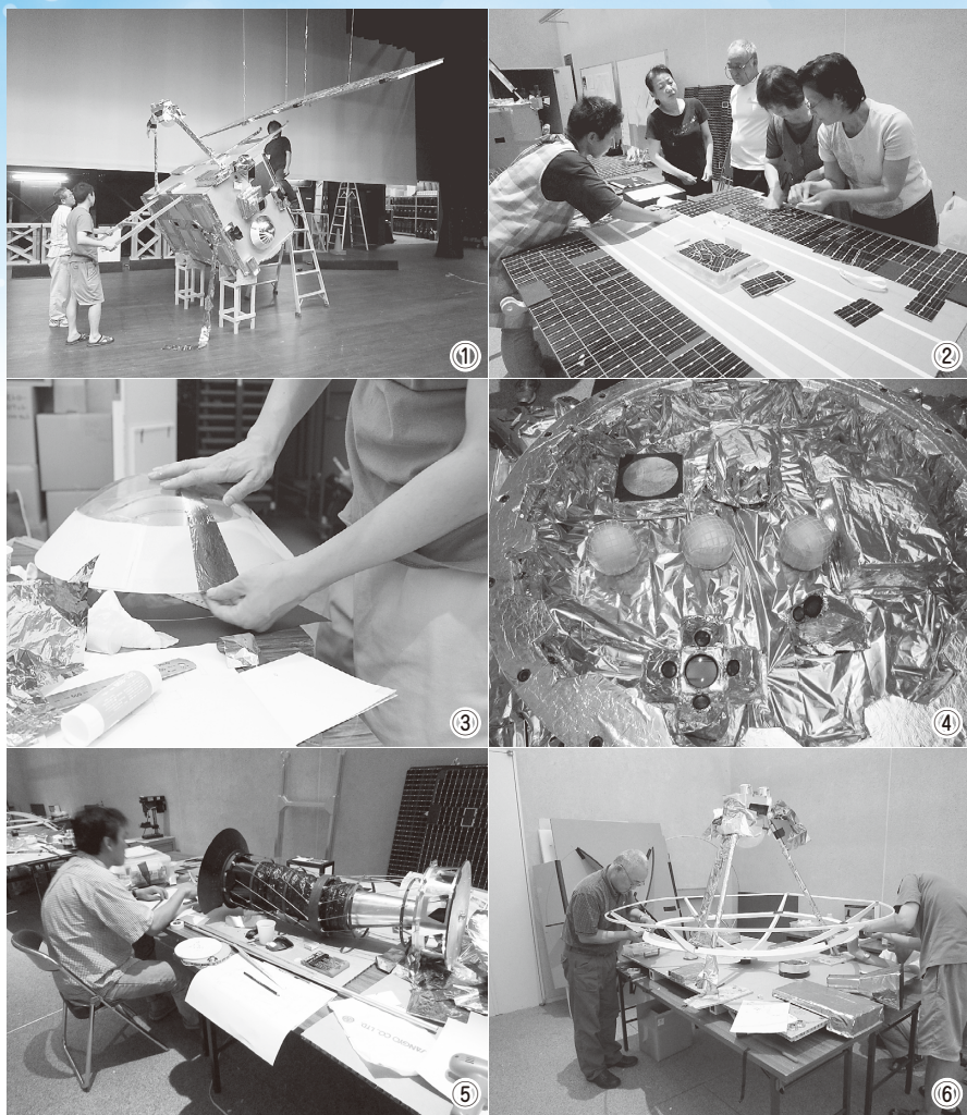
①模型を組み立てて、全体のバランスをチェック②A3版の光沢紙に印刷して、名刺2枚分ほどの大きさに裁断したもの一枚一枚貼り付けて太陽光パネル模型を作製③カプセル模型も大切に手作り④本物と同じ反射材を使ったターゲットマーカー模型⑤蛇腹も丁寧に再現したサンプラーホーン模型⑥パラボラアンテナ模型は3台目でようやくこん身の出来に
