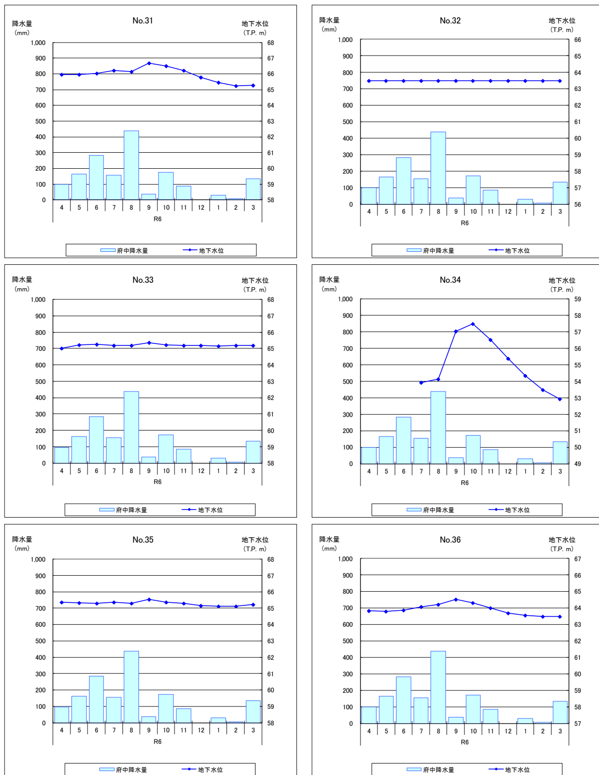
図-3.2(5) 地下水位測定結果及び気象庁府中観測所雨量 (5/6)
