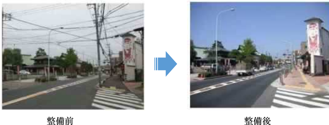
図 8-19 無電柱化整備事例
