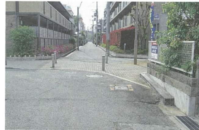
写真 2.2.2.35 交差点遮断 (兵庫県尼崎市塚口地区)
