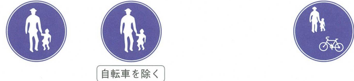
図 2.2.1.3 道路標識 (325 の 4) 歩行者専用 (参考) 道路標識 (325 の 3) 自転車及び歩行者専用 ■ 設置事例
