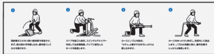
※2：消火栓(初期消火訓練)スタンドパイプ使用方法
